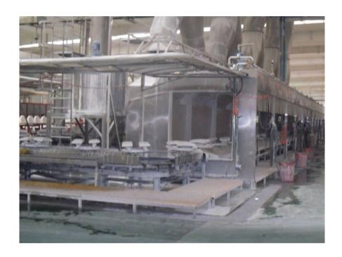
该设备可用于不同规格卫生洁具坯体的除尘、施釉及釉浆回收,此施釉线为自动循环线,可一线完成 坯体吹尘、清洗、喷釉、贴标等多道工序,保证产品品质的均一性。具有低功率、低噪音、清洁环保 等特点,可有效提高施釉效果,减轻工人的劳动强度,极大的提高工作效率。
