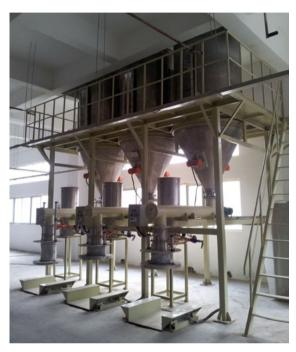
由除尘机、料仓、螺旋给料机、除尘管道、自动称量平台、搅拌机等构成。 主要技术性能及参数
