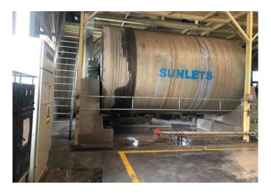
该系列产品是湿法间歇式细磨设备,用于陶瓷原料及其它原料的精磨与混合,出料粒度可达 100 目以上,精磨后的泥浆通过过筛、除铁等处理后用于陶瓷生产。
