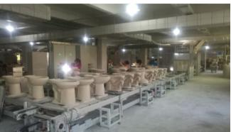
半检流水线是用于干坯在线检验的自动化搬送设备,只需要工人在线对干坯进行擦拭和检验,坯体的搬送通过流水线自动输送,能够有效的减少坯体的搬放次数,提高生产效率,降低坯体破损率,降低工人劳动强度,同时取消搬送车,改善现场环境。
