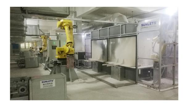
机器人施釉工作站,采用机器人双工位施釉,改变了施釉人员与釉料直接接触的传统施釉方式,改善了工作环境,降低了工人的劳动强度,提高了施釉效率,降低了用工成本。同时,通过本站施釉后的产品,釉厚均匀、质量稳定、合格率高。
