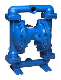
气动隔膜泵是一种新型的输送泵,该泵以压缩空气为动力,主要用于陶瓷行业输送泥、釉浆,其中尼龙材质泵可直接用于施釉,从而取消施釉压力罐,减少对釉浆可能造成的污染。
