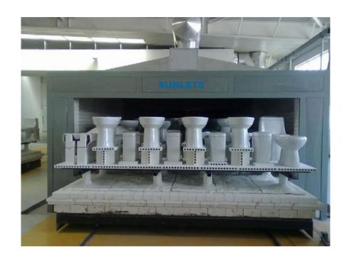
烧成温度: 1150-1280 烧成周期: 12-18 小时燃料: 天然气, 焦炉煤气 年产量: 60-80 万件
