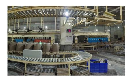
智能座便器全自动高压成型生产线是我公司自主研发的卫生陶瓷高压成型设备,是全球第一条智能马桶高压生产线。与传统智能马桶生产线相比,具有三大优势:作业人员节省70%、占地面积节省70%、能源消耗节省70%。
