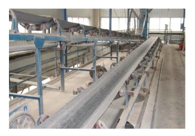
皮带输送机是大型球磨机装料的辅助装置, 与斗提式升降机配合可有效的降低工人的劳 动强度,而且下料均匀、快速、操作简单。 可根据用户的要求设计制作。
