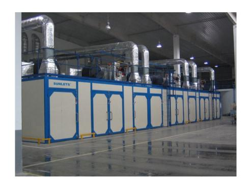
本设备主要适用于成型车间湿坯干燥和模具车间的模具干燥。干燥室通过自动控制器对干燥室内的温湿度精确控制和调节,形成可靠有效的温湿度曲线,保证品质的条件下,在最短的时间内干燥坯体或模具。整套设备实现全自动控制,采用先进的 PLC + 触摸屏形式,可视化效果好,操作简单,温湿度调节方便。此设备占地面积小,工作效率提高,是适合陶瓷生产企业新技术革新改造的重要一环,此干燥室亦可设计成连续干燥的形式。
