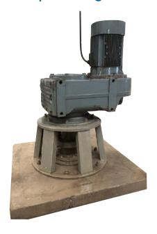
主要是在建筑卫生陶瓷行业中用来搅拌泥浆,使贮存在泥浆搅拌 池内的固体颗粒不发生沉淀,经搅拌叶的旋转搅动,达到保持泥 浆均匀悬浮的目的。
