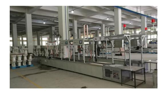
成瓷检验线实现了卫生制品从外观检验、性能检测、打包装箱等步骤的流水线作业。主线由传动辊、 皮带进行制品传送,配有外观检查台、漏水检验机、冲水试水检验机、水件装配装置,打包装箱装置 等(根据客户需求安装)
