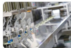
下料输送平台 Material inputting conveyor
